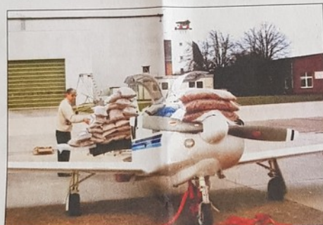
Knut Marthiens führt 1994 mit Sandsäcken nach dem Bau seiner Glasair II einen Belastungstest durch. • Foto: Privat
